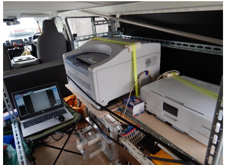
暗室不要の CR システムにより、レントゲン撮影後の工程をデジタル化。現場へ持ち込みその場で現像することも可能です。
