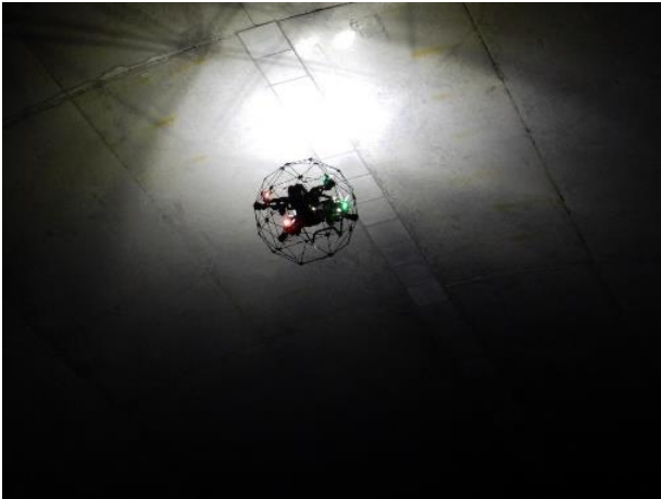
屋内点検用球体ドローン「ELIOS2」による空撮風景
